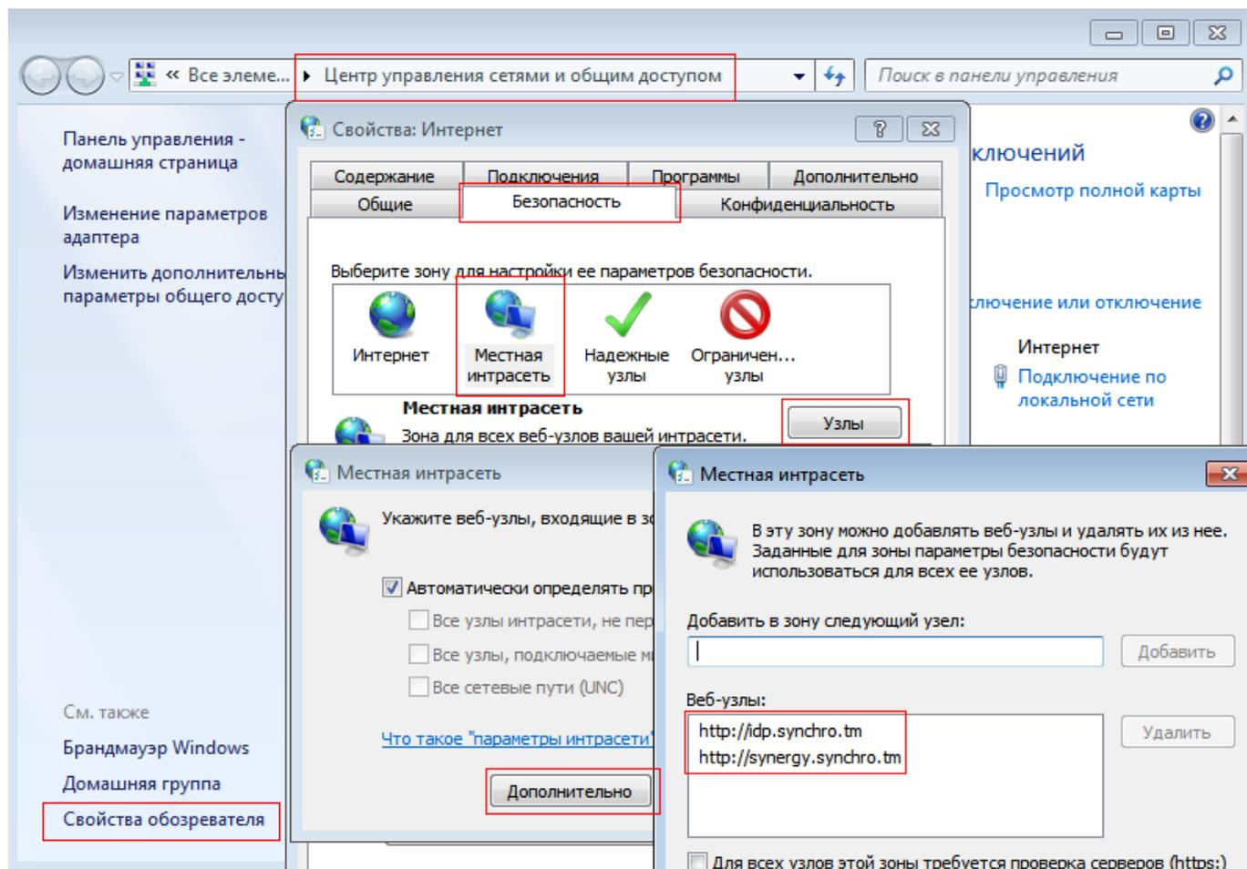
Figure 6.39: Добавление узлов в интрасеть
