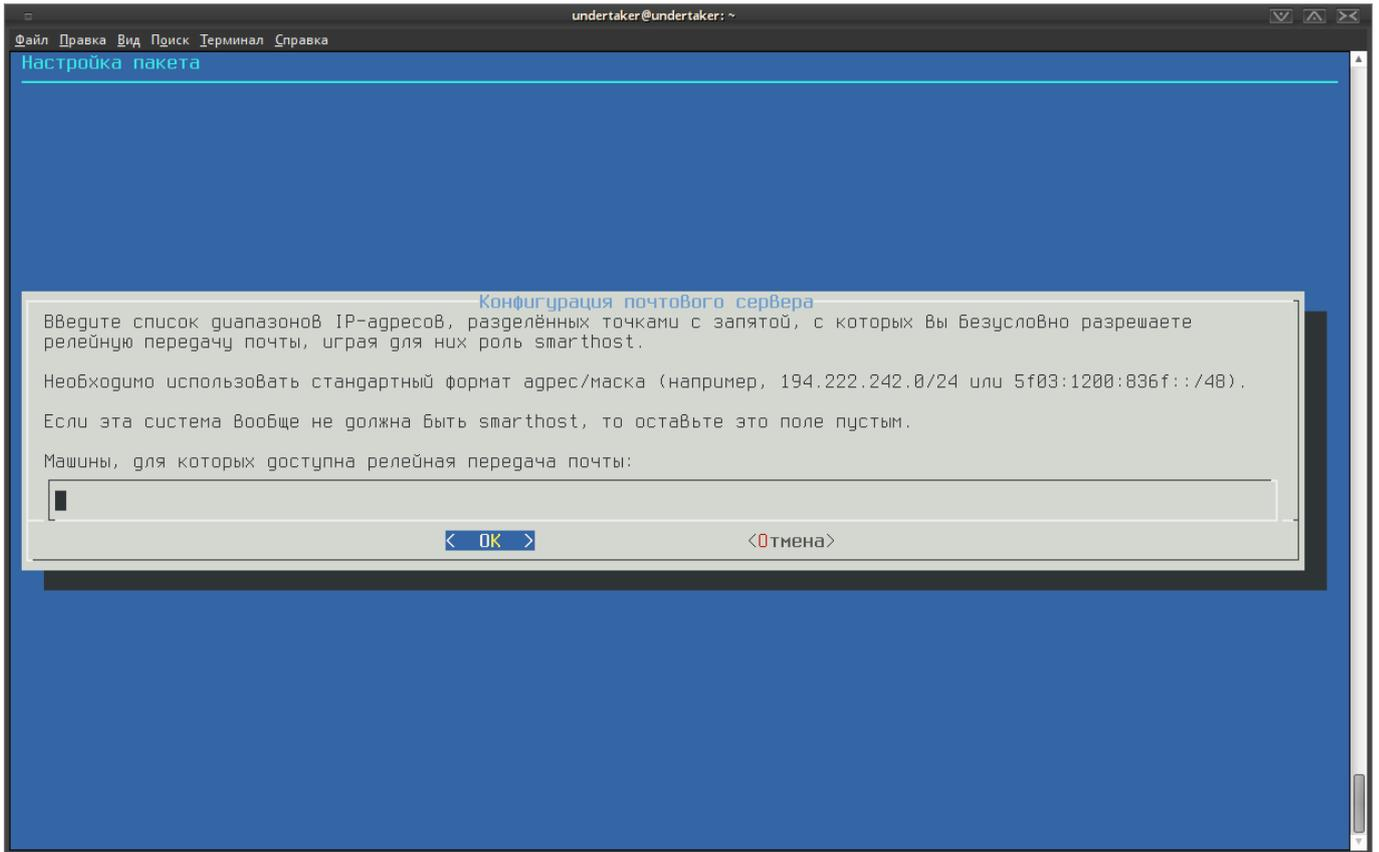
Figure 6.22: Релейная передача почты
