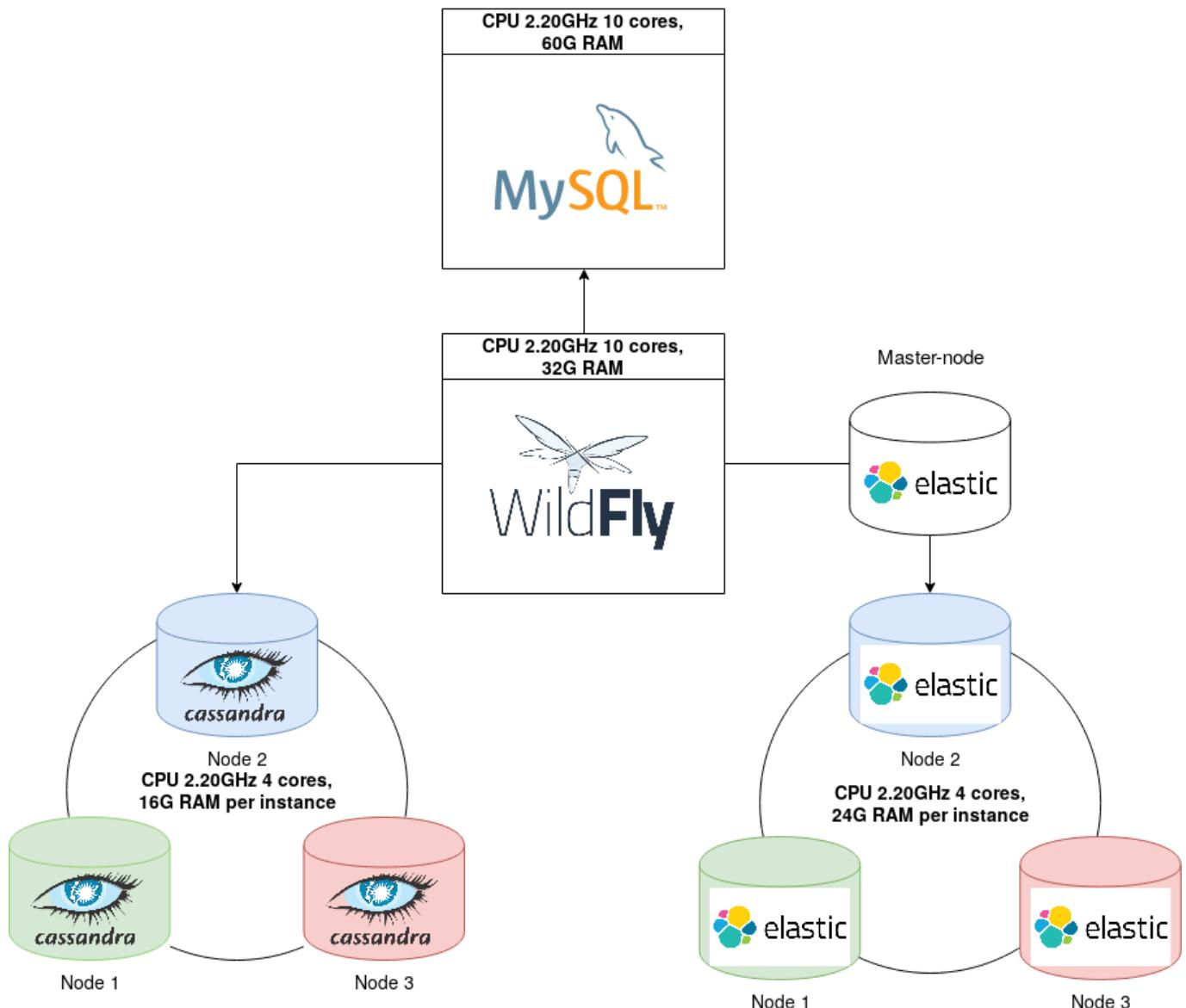
Figure 3.8: Конфигурация серверов
