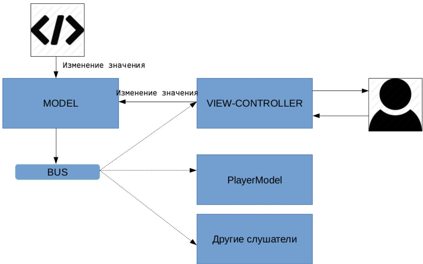
Рис. 1.9: Схема 3, процесс изменения значения компонента
