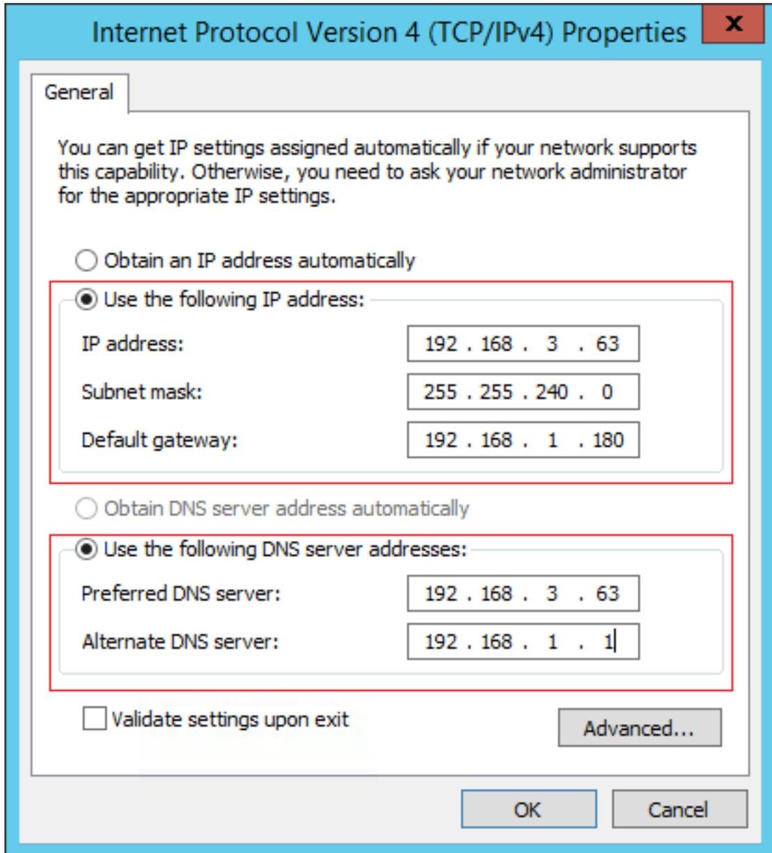
Figure 5.53: Настройка статического IP-адреса
