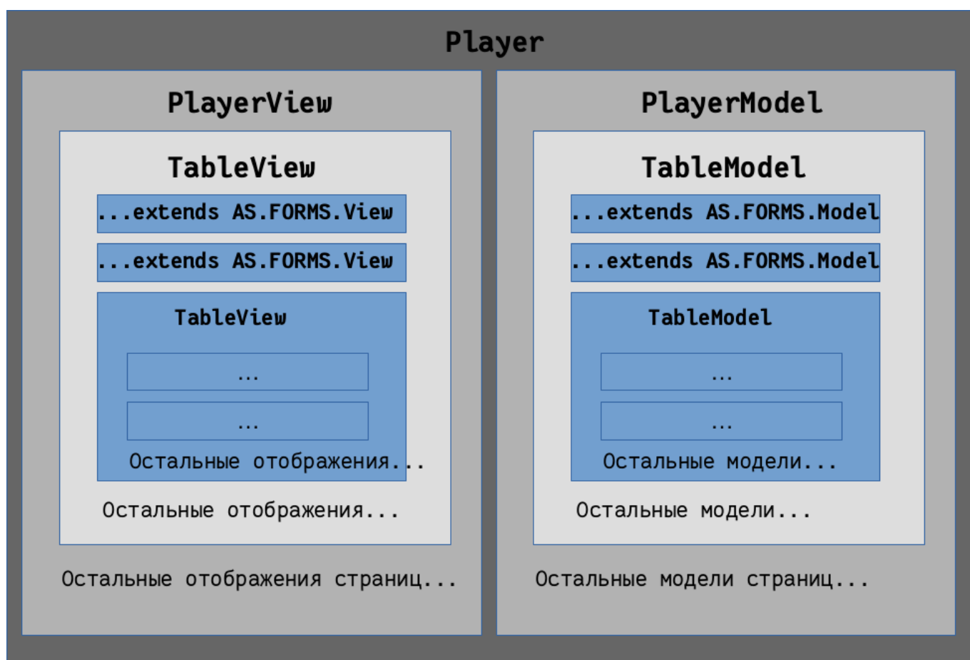
Рис. 1.7: Схема 1, общая схема работы проигрывателя
